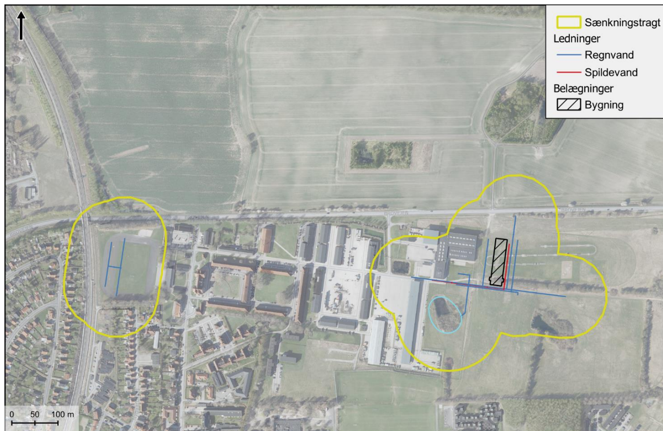
Figur 2 Beregnede sænkningstragter, der er beregnet ud fra en meget konservativ hydraulisk ledningsevne for hver af de to lokationer.
